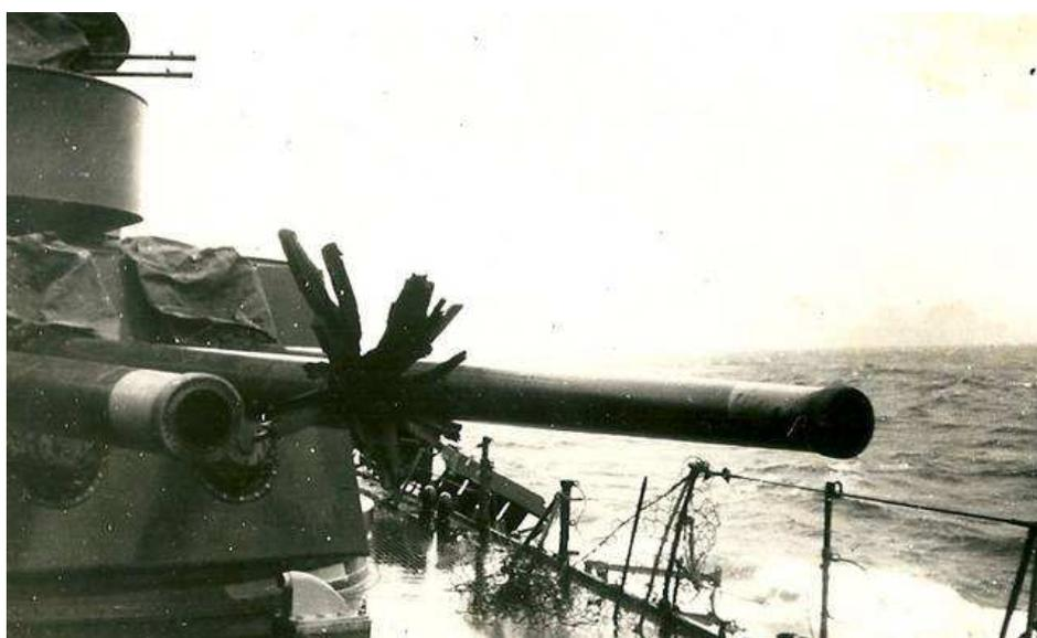
La torre da 152 mm del *Littorio* messa fuori combattimento dall’esplosione di un proiettile nel cannone centrale, probabilmente causato da un colpo delle navi britanniche.
