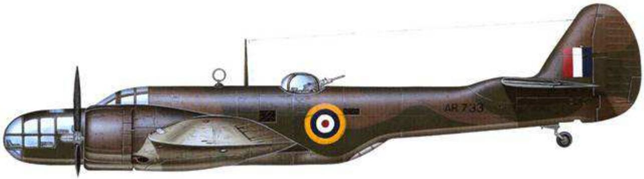
Disegno pittorico di un Martin Maryland, impiegato dalla RAF nei compiti di ricognizione e di bombardamento.
