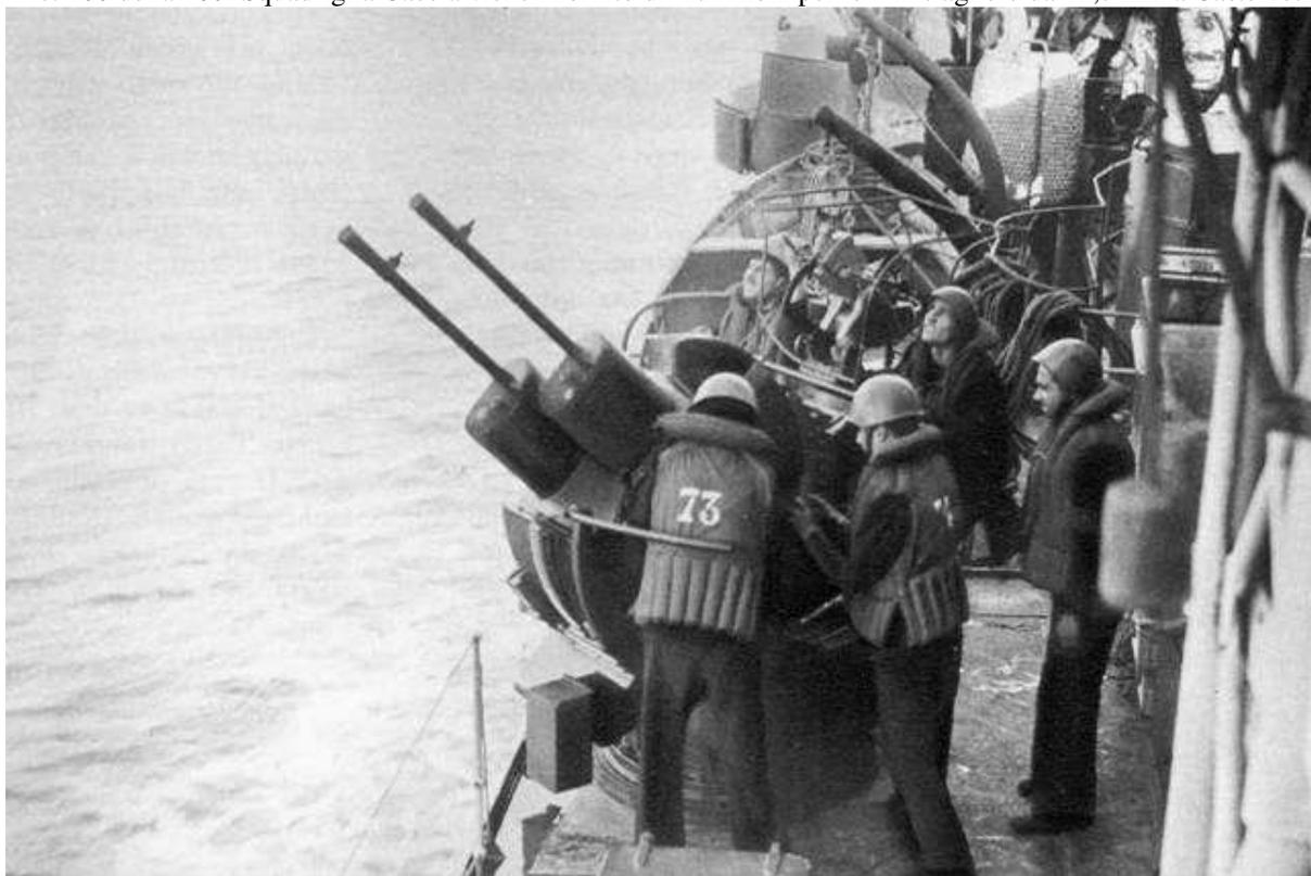
Un complesso di mitragliere binate da 20 mm Breda su una silurante italiana. Era questo il tipo di armamento, dalla portata massima di 2.500 metri, di cui potevano valersi i CT e le torpediniere impegnate sulle rotte dei convogli e per la difesa delle formazioni navali. Invece i corrispondenti mezzi navali britannici, avendo i pom-pom in impianti quadrupli da 40 mm, potevano sparare a una distanza di 4.000 metri, utile anche nel tiro navale.
