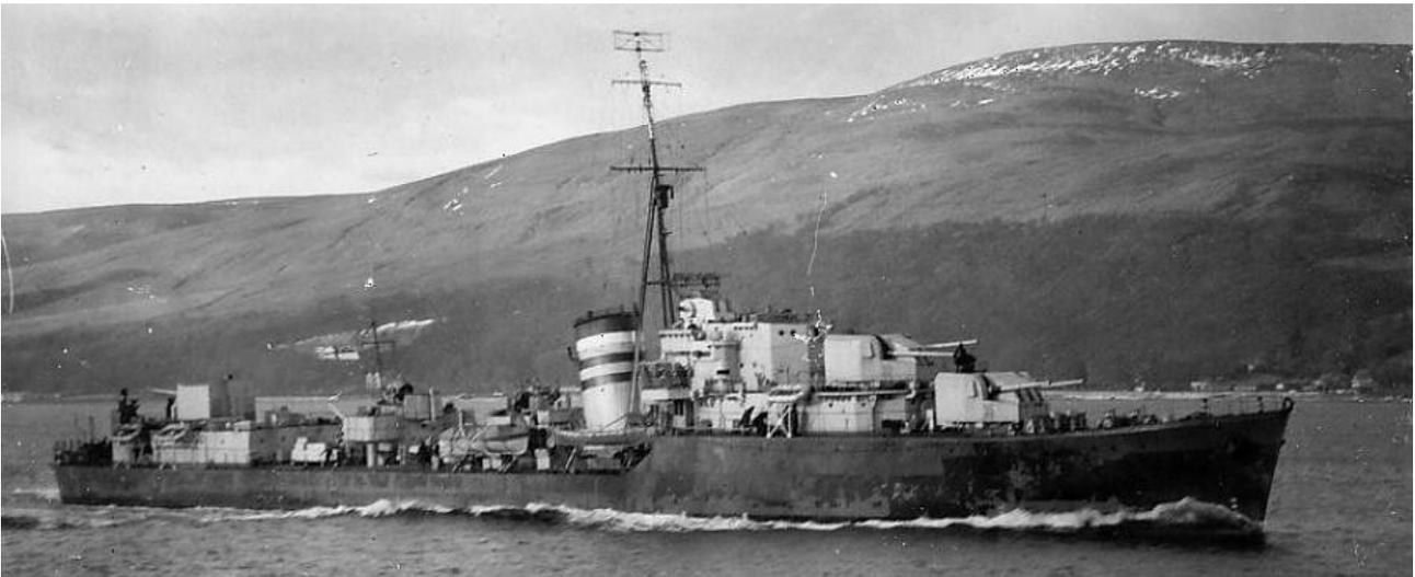
Una bella immagine del CT *Laforey*, armato con sei cannoni da 120 mm ad alta elevazione (55°) in torrette stagne. Assieme ad altra unità della stessa classe, il *Lightning*, sostituì a Gibilterra i gemelli CT *Lance* e *Lively*, trasferiti a Malta.
