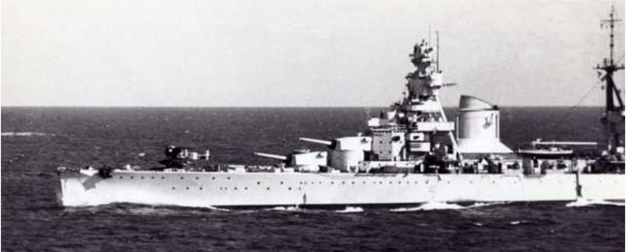
L'incrociatore pesante *Trento* in navigazione di guerra nel 1940. Notare di prora il velivolo idrovolante Ro. 43 impiegato per ricognizione e, all'occorrenza, per la direzione del tiro. Per questi motivi, oltre al pilota dell'Aeronautica, aveva sempre a bordo un qualificato ufficiale osservatore della Marina.
