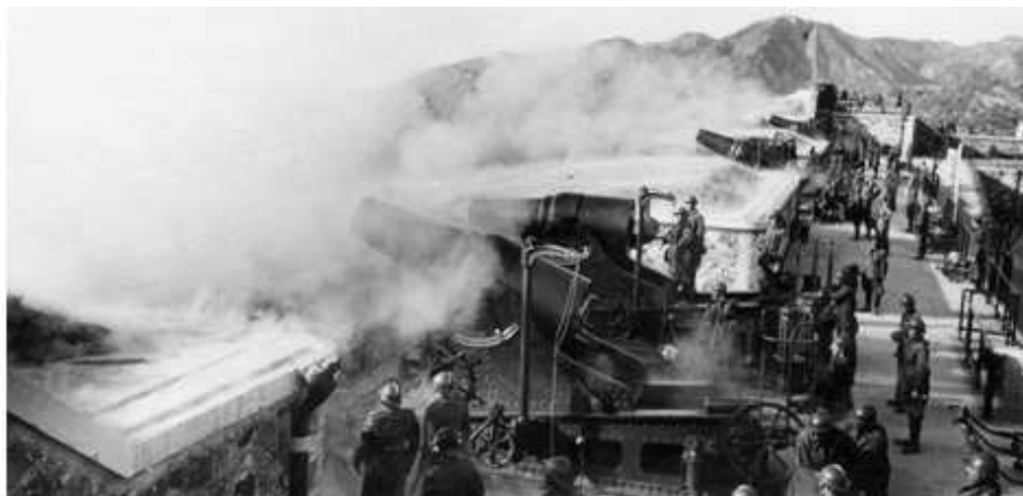
Messina. Batteria Schiaffino, militi della 6 a legione Milmart impegnati nei tiri di esercizio con i 6 vetusti mortai da 280/9 in dotazione. I pezzi sono incavalcati su affusto da difesa, con fianchi scorrevoli sulle lisce inclinate del sott'affusto a molle a perno centrale. (collezione F. Riccobono)
