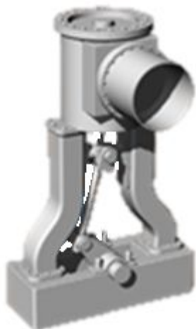
Fig. 7. Macchina a vapore alternativa verticale “a cilindro capovolto”. Disegno dell'autore.
