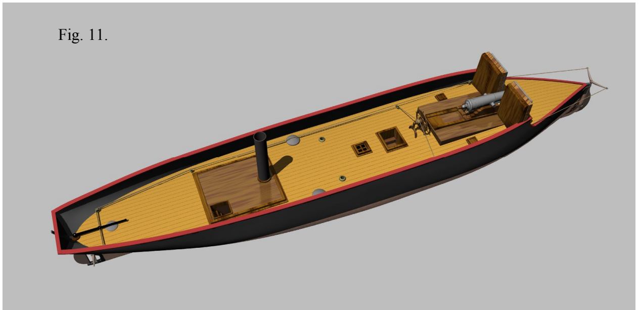
Fig. 10-14. Viste di un disegno delle cannoniere realizzato in base ai piani dall'autore in tecnica computerizzata 3D. Nella fig. 14 è stata rappresentata l'impavesata amovibile di prua
