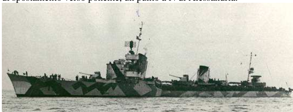
Il CT Malocello nella primavera del 1943 quando aveva ricevuto un radiolocalizzatore tedesco. Notare l'antenna ruotante sopra il ponte di comando.
