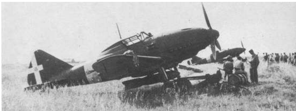
I due caccia Re. 2001 della Sezione Speciale, armati ciascuno con la bomba antinave perforante da 630 chili, che il 12 agosto ebbero il compito di attaccare a volo radente le portaerei britanniche per menomarne il ponte di volo.
