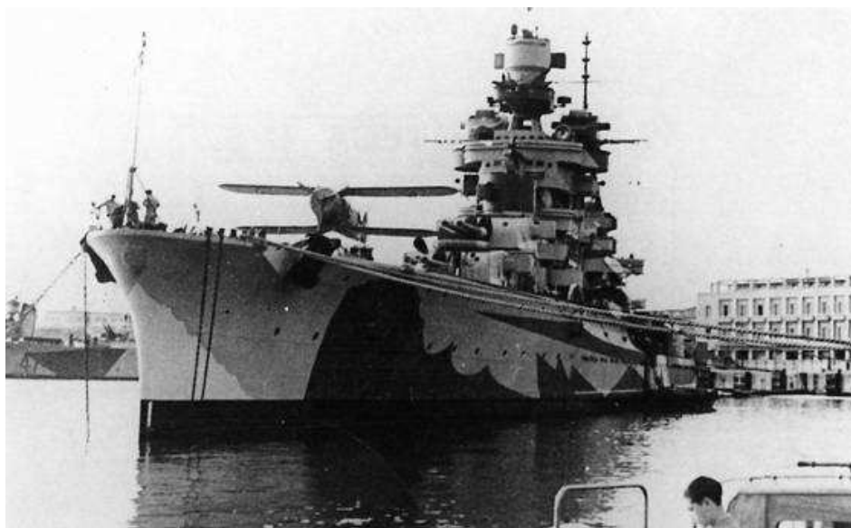
L'incrociatore pesante Gorizia, nave di bandiera del Comandante la 3a Divisione, ammiraglio Angelo Parona, a Messina nella primavera del 1942. A prora, sulla catapulta, è il velivolo da ricognizione Ro. 43.
