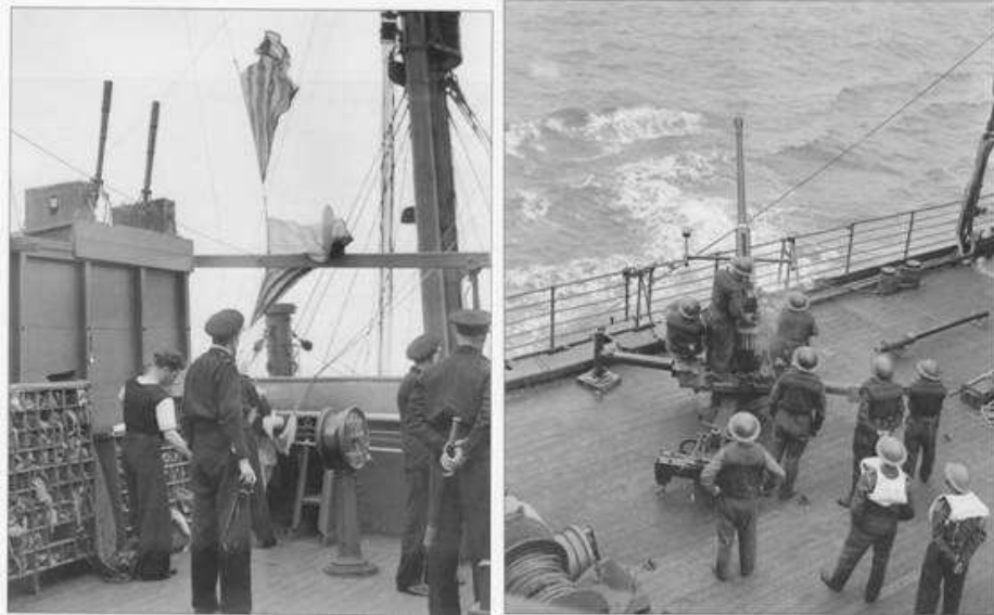
Sempre sul Melbourne Star. A sinistra il ponte di comando da cui si eseguono segnali a bandiera; a destra, un cannone singolo da 40 mm. Bofors, temporaneamente sistemato sul fianco sinistro del piroscafo per aumentarne le capacità di difesa contraerea.
