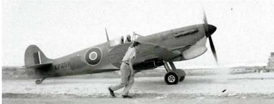
Uno Spitfire del 126th Sqn in rullaggio a Luqa. Notare sotto l'elica il grosso filtro anti-sabbia, utilissimo nel deserto e in aeroporti polverosi come quelli di Malta, ma che, nonostante il più potente motore da 1470 HP, riduceva di circa 15 Km/h la velocità del velivolo, che risultava pertanto più bassa di quella dei Bf 109 tipo F e G e degli Mc.202.
