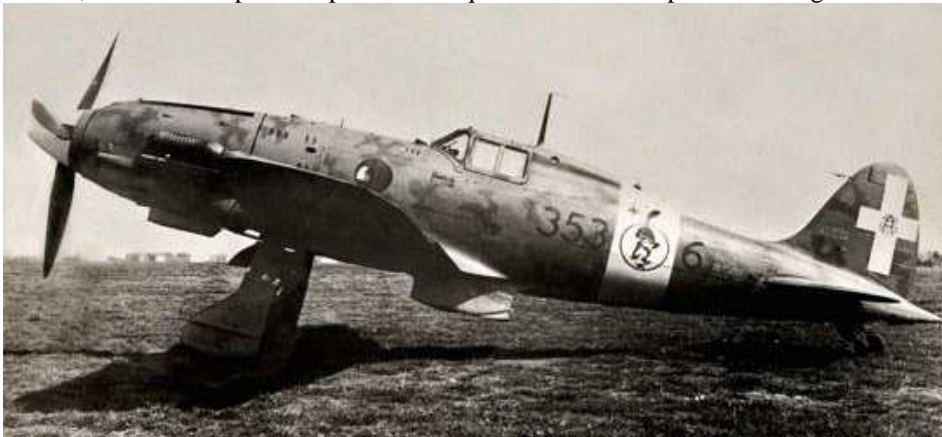
Un Mc 202 della 353a Squadriglia del 155° Gruppo del 51° Stormo Caccia. Per velocità e maneggevolezza poteva competere con gli Spitfire V fino alla quota di 7000 m, ma era inferiore per potenza del motore Daimler Benz (1175 HP contro 1470 HP) e armamento (2 mg da 12,7 e due da 7.7 contro 2 cannoncini da 20 mm e 4 mg).
