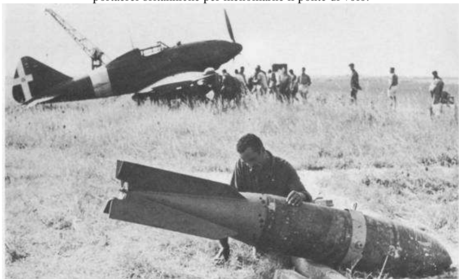
La grossa bomba perforante mentre viene controllata da uno specialista. Sullo sfondo, mediante appositi carrelli, si sta imbarcando un'altra bomba a bordo di uno dei due Re. 2001. Gli speciali ordigni stavano per essere impiegati per la prima volta.
