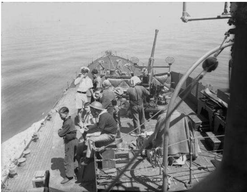
Pure le unità da guerra furono dotate di armi c/a di fortuna. Un complesso Bofors da 40 m/m in uso dall'esercito sistemato sulla torre B dell'incrociatore Manchester.
