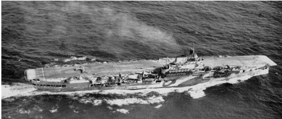
L'Indomitable nell'Oceano Indiano nella primavera del 1942. La foto mostra la mimetizzazione chiara che la fece scambiare agli osservatori dell'Asse per una portaerei americana (la Wasp). Come la gemella Victorious, aveva buona velocità, ma il vantaggio di un hangar corazzato limitava la componente aerea a circa 50 velivoli.
