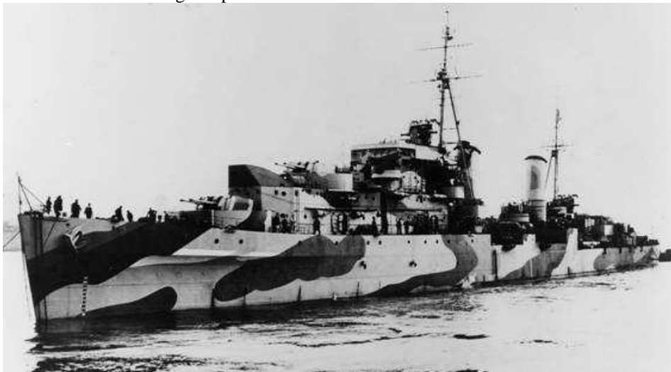
L'incrociatore Charybdis che la sera del 12 agosto fu mandato a rinforzare Forza X. Il Charybdis e il gemello Scylla avevano due sole torri prodriere binate da 133 mm invece delle tre della classe "Dido".
