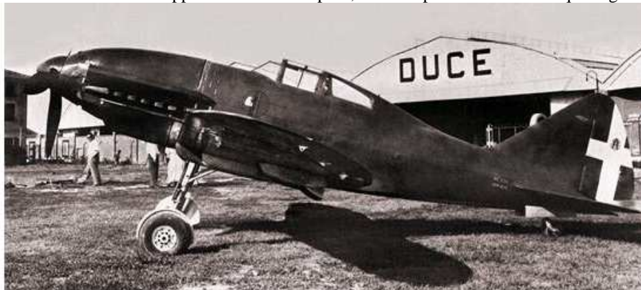
Il caccia Reggiane Re. 2001. Pur avendo il motore tedesco Daimler Benz D.B. 601/A-1 da 1.175 cavalli, che equipaggiava pure l'Mc. 202, per la sua insufficiente velocità e lo scarso armamento, rispetto alla Spitfire V con motore Merlin da 1.470 cavalli, costituì una cocente delusione per i piloti italiani, che nei combattimenti sul cielo di Malta del maggio e giugno 1942 riportarono perdite, senza conseguire successi apprezzabili.
