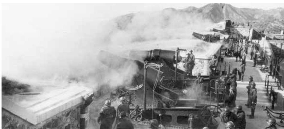
Messina. Batteria Schiaffino, militi della 6<sup>a</sup> legione Milmart impegnati nei tiri di esercizio con i 6 vetusti mortai da 280/9 in dotazione. I pezzi sono incavalcati su affusto da difesa, con fianchi scorrevoli sulle lisce inclinate del sott'affusto a molle a perno centrale. (collezione F. Riccobono)
