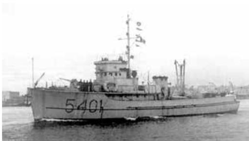
Nel 1947 vennero acquistati dagli Stati Uniti 17 YMS, unità di nuova generazione (varati nel 42/43), che costituirono la classe "400" o classe *Fiori*. Avevano lo scafo in legno ed erano dotati di doppio cavo di dragaggio, di apparecchiatura magnetica ed
