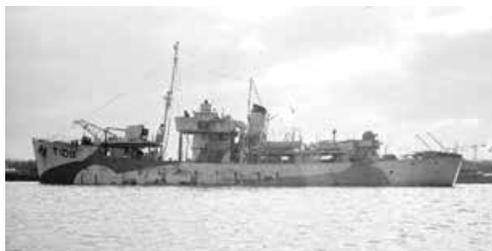
di 16 dragamine meccanici da 500 tonnellate (Dance-class trawler), aventi scafo in ferro sufficientemente smagnetizzato e dotati di apparecchiatura meccanica del tipo "oropesa". Il primo gruppo costituì la classe "200" e svol-
